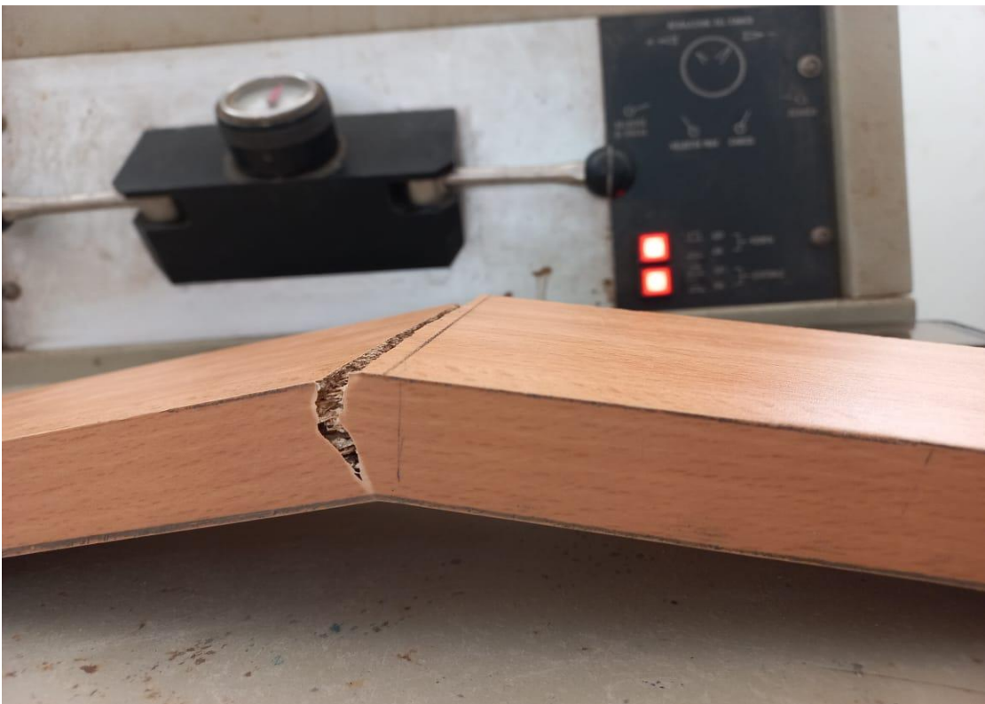
Fuguer5 : représente la fissuration d'échantillon après un test de flexion
