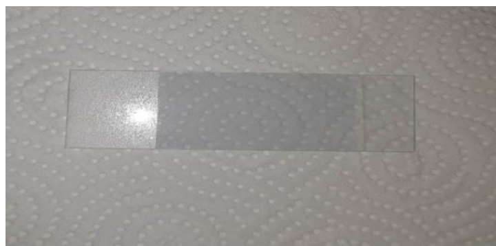
Figure III.3. Dépôt Acétate de zinc sur substrat en verre (35% V/V)
