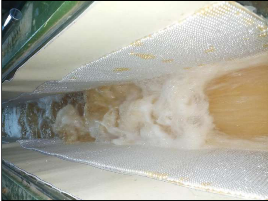
Photo 1. 15 : Création du ressaut hydraulique aux parois rugueuses.
