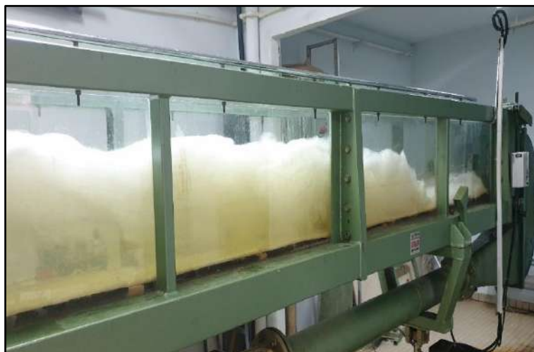
Photo 1. 2 : Ressaut hydraulique obtenu à l'Université de Ouargla (Département de Hydraulique et Génie civile) par BRAHIMI Abdelouahed (2022). L'eau s'écoule de droite à gauche. Fr_1=12,6 ; h_1=2 cm.
