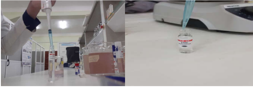
الصورة 10: اخذ عينة من الأنبوب TOC ونضعها في الأنبوبة TOC
