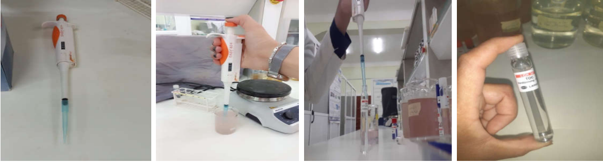
الصورة 9: بالماصة نأخذ عينة من الماء ونضعها في الأنبوبة
