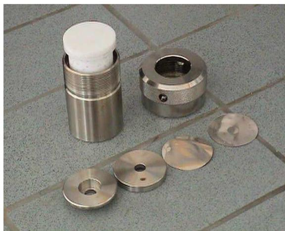
**Figure2-1: autoclave et ces principaux composants**
