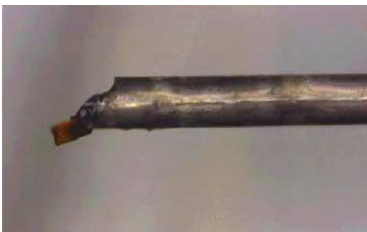
**Figure2-4 :Un monocristal monté à un capillaire**
