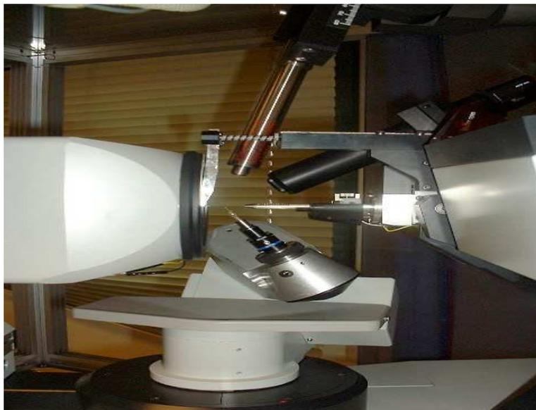
Figure 2-5 : Diffractomètre NONIUS à géométrie Kappa
