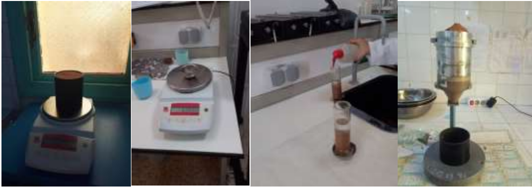
الصورة (39): تجربة نفاذية التربة.
