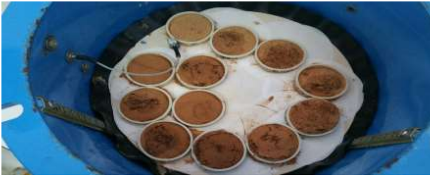
الصورة (41): جهاز الضغط المستخدم في تحديد السعة الحقلية ونقطة الذبول
