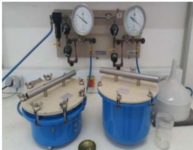
الصورة (42): جهاز الضغط المستخدم في تحديد السعة الحقلية ونقطة الذبول
