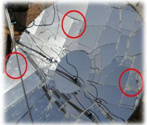
Figures III.6. Défauts de dimensions au centre de la parabole solaire
