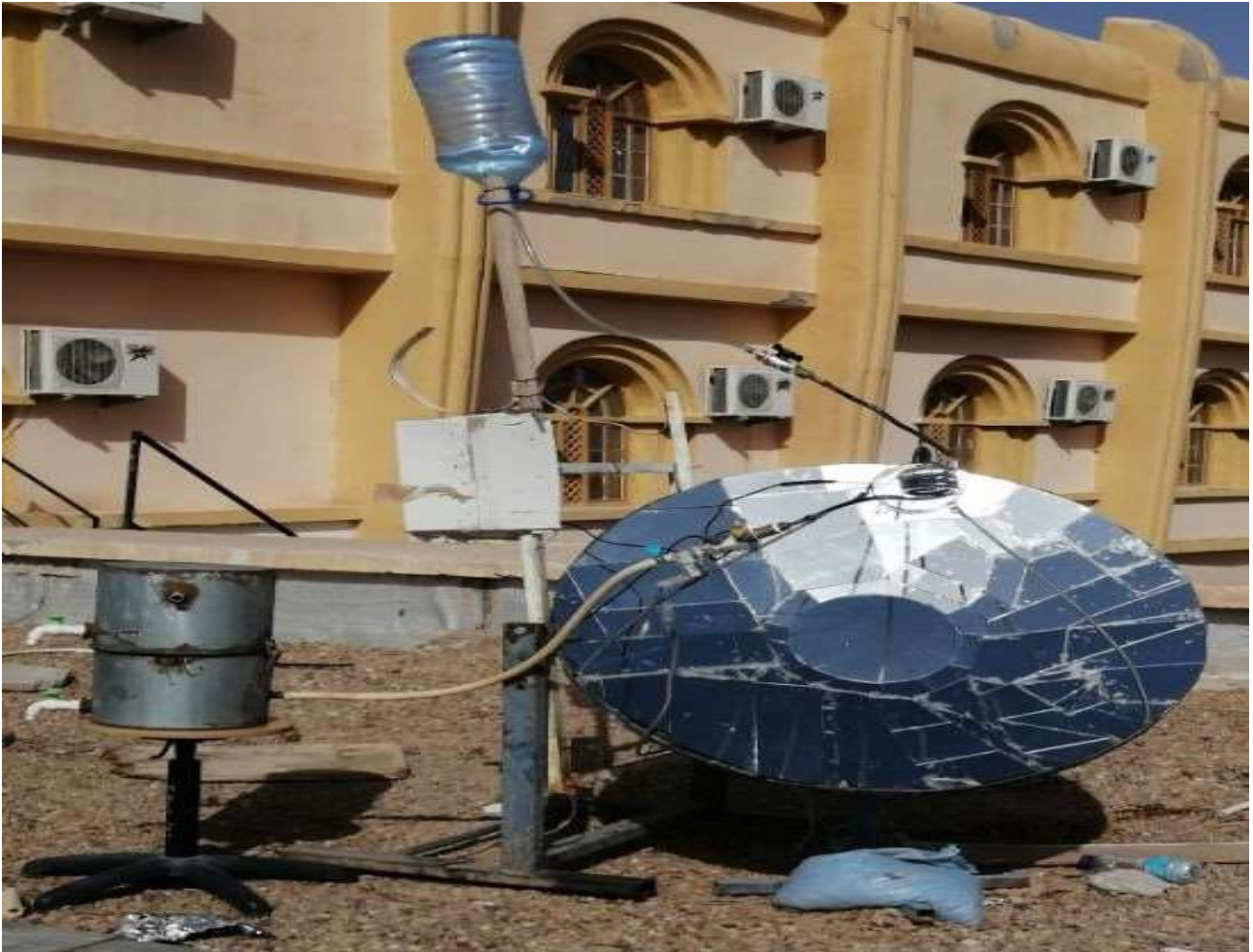
Figure .II .2: Photo du distillateur solaire avec tous ses composants
