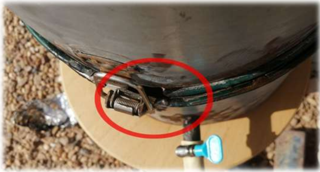
Figures III.8. Lieu de fuite dans le distillateur
