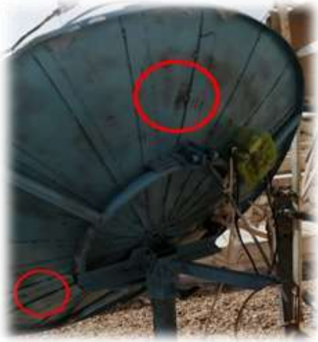
Figures III.6. Défauts de dimensions au centre de la parabole solaire
