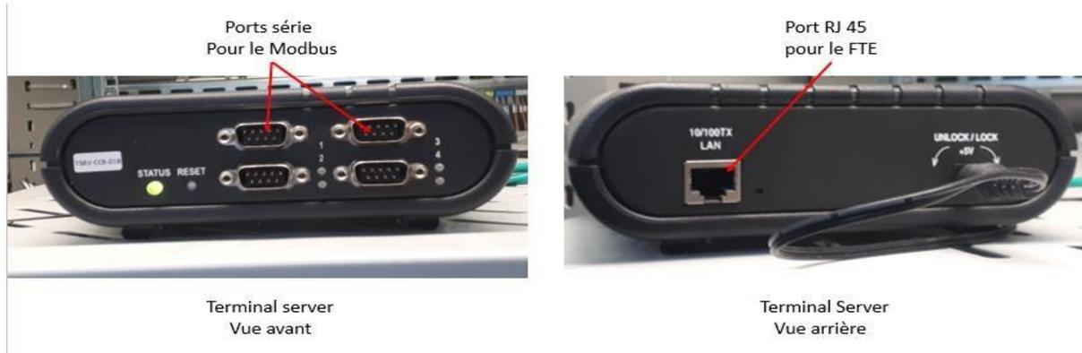
Figure 6. Illustration d'un terminal server
