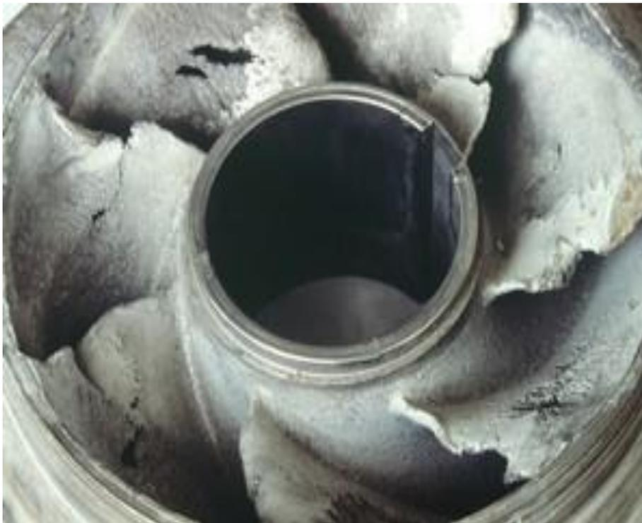
*Figure 2.11. Cavitation des pompes*
