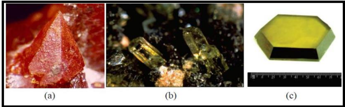
Figure I.5 Oxyde de Zinc ( ZnO ) massif sous forme naturelle (a) et (b) et provenant de synthèse hydrothermal (c). Sa couleur varie suivant les impuretés qu'il contient : sa couleur rouge par exemple, est due à la présence de manganèse au sein du matériau. A l'état pur, il est transparent [17].
