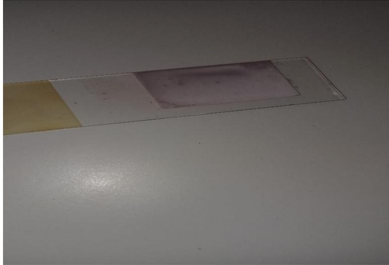
الشكل III-6- الركيزة بعد نقع في المحلول العضوي غسلها بالماء المقطر
