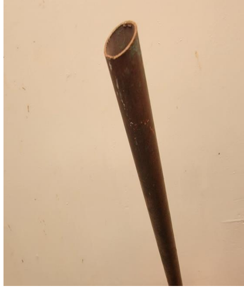
شكل 9: شكل يوضح العنصر النحاسي الناقل للحرارة
