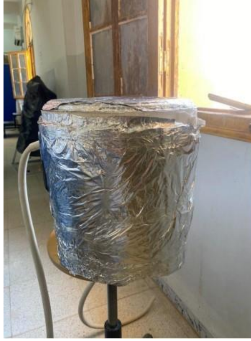
شكل 10: شكل يوضح تصميم خزان الحصى بمخرجين علوي و سفلي
