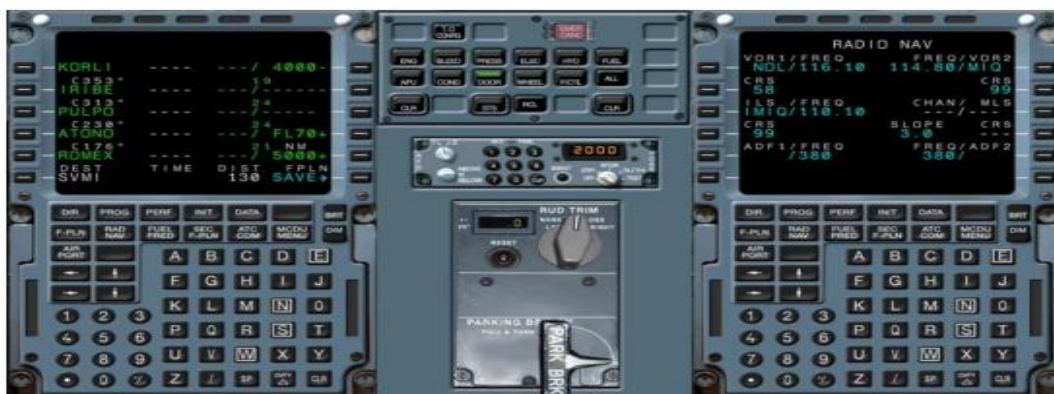
Figure 3.4: Les deux MCDU de a330.[f5]
