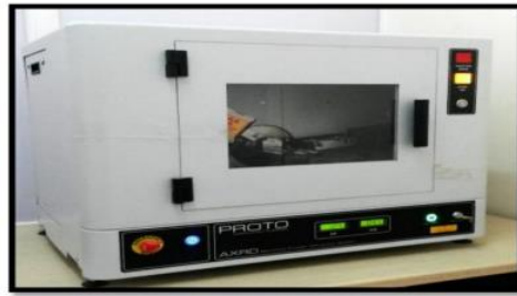
الشكل (12.II) : جهاز انعراج الأشعة السينية (DRX)
