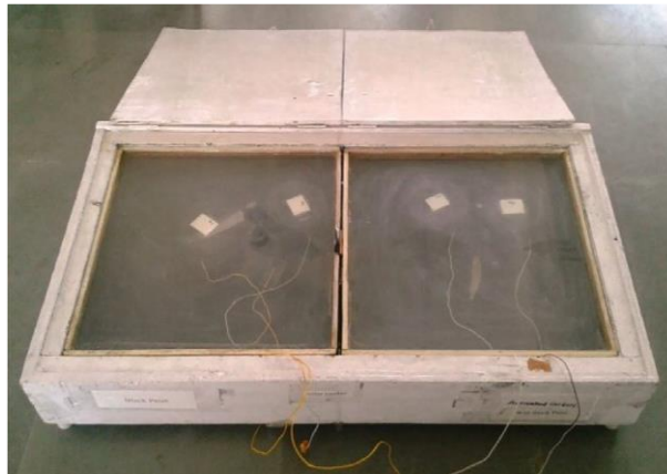
الشكل 2 – 2 : قياس درجة حرارة الطباخ الشمسي مع الحمل في وعائين مع مواد طلاء مختلفة [14]
