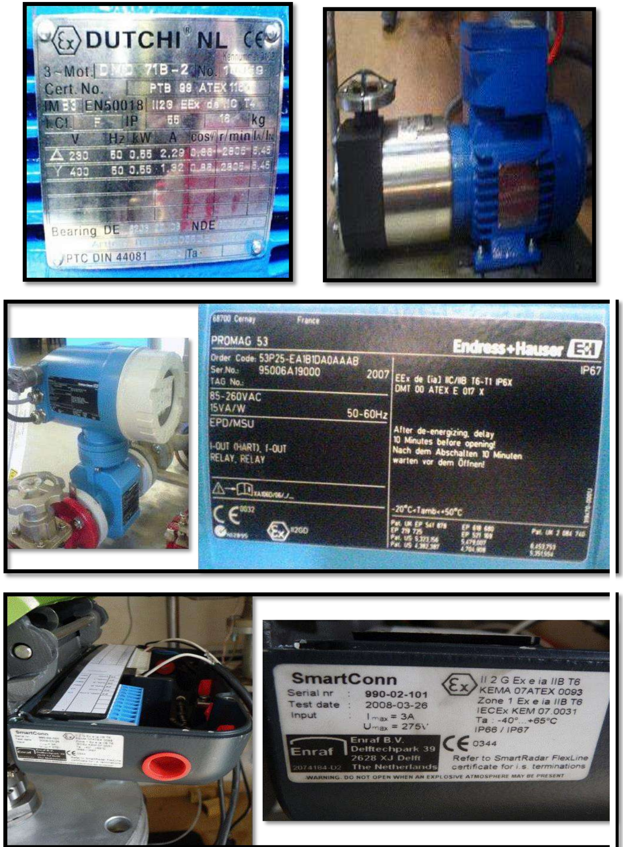
Figure III05: Marquage ATEX des équipements.
