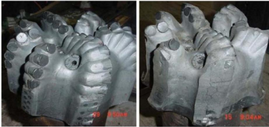
Figure II-3: Gauche: Outil Neuf, Droite: Outil Ayant Subi des Vibrations Sévères [23]
