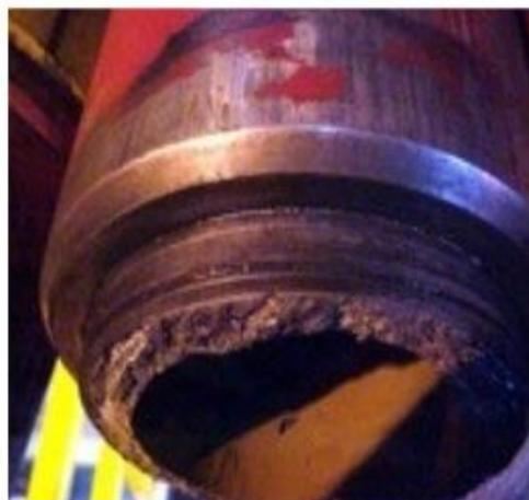
Figure II-2: Rupture d'une Tige de Forage[23]
