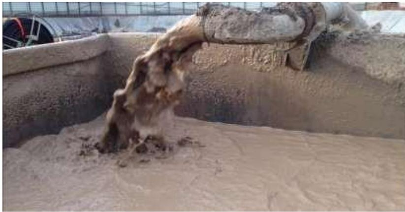
**Figure II. 10:** Boue de forage.
