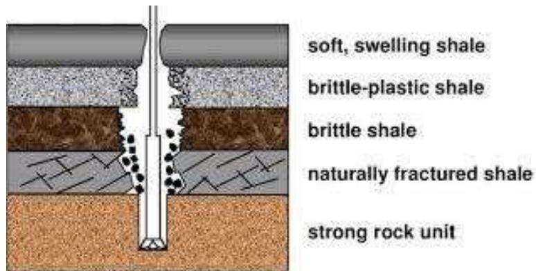
**Figure II. 19:** Coincement cause des instabilités des parois du puits.
