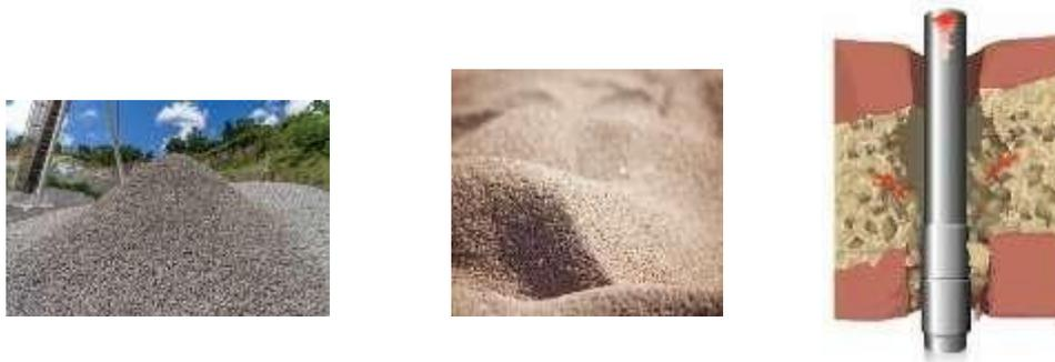
**Figure II. 13:** Coincement cause de formations non consolidées.
