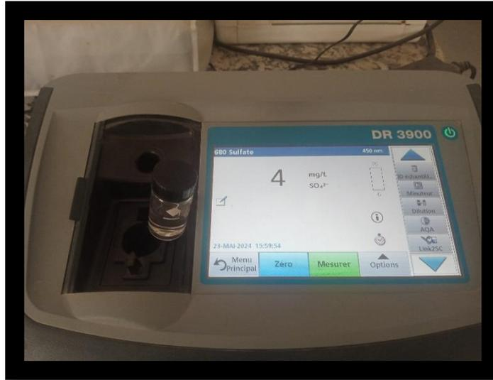
*Figure.IV.14. Spectrophotomètre DR 3900 avec cellule de Sulfate*
