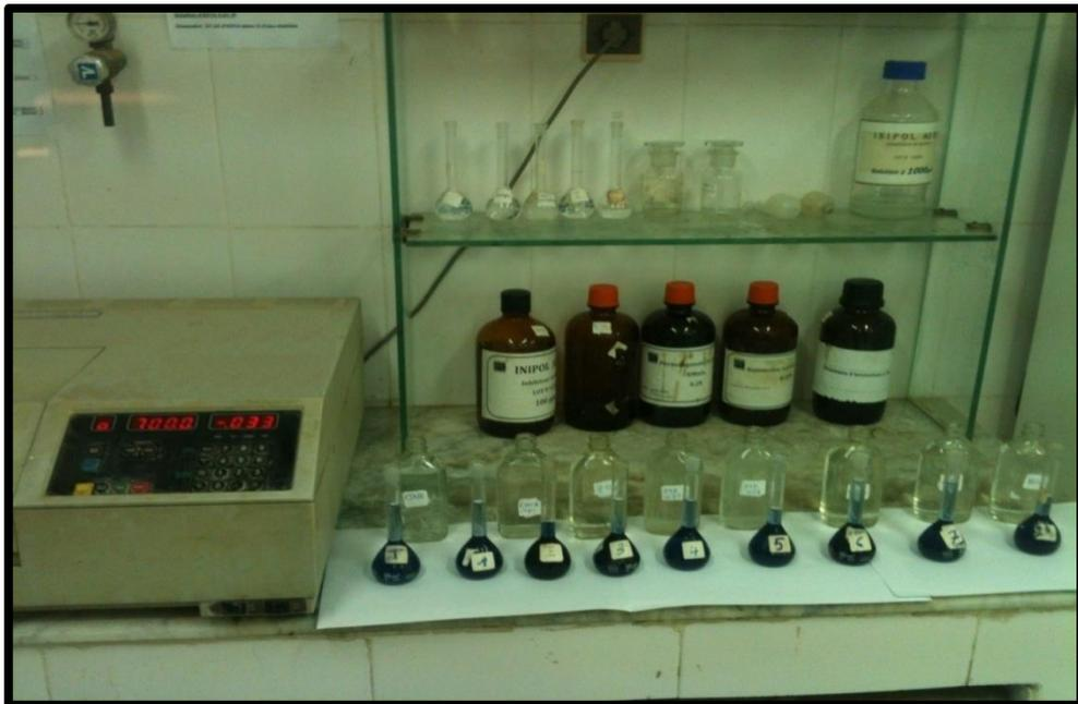
*Figure.IV.21. Contrôle de la concentration de l'anti-Dépôt par le spectrophotomètre UV-Visible*
