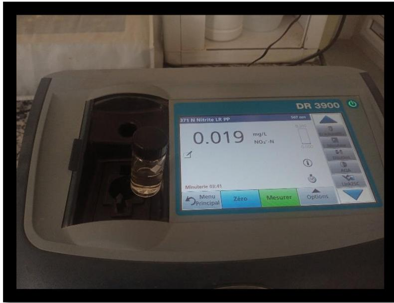
*Figure.IV.16. Spectrophotomètre DR 3900 avec cellule de Nitrite*
