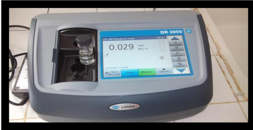
Figure.IV.15. Spectrophotomètre DR 3900 avec cellule de Phosphate
