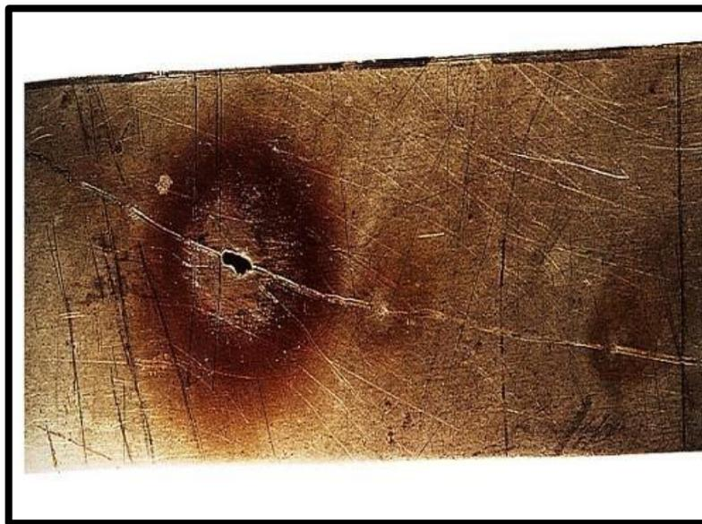
*Fig. I.4. Corrosion par piqûres sur la paroi d'une cuve en acier Inoxydable austénitique Cr18- Ni10*
