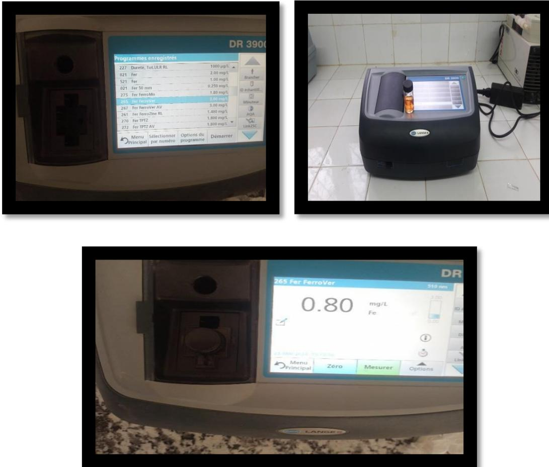
Figure.IV.13. Spectrophotomètre DR 3900 avec cellule de Fer
