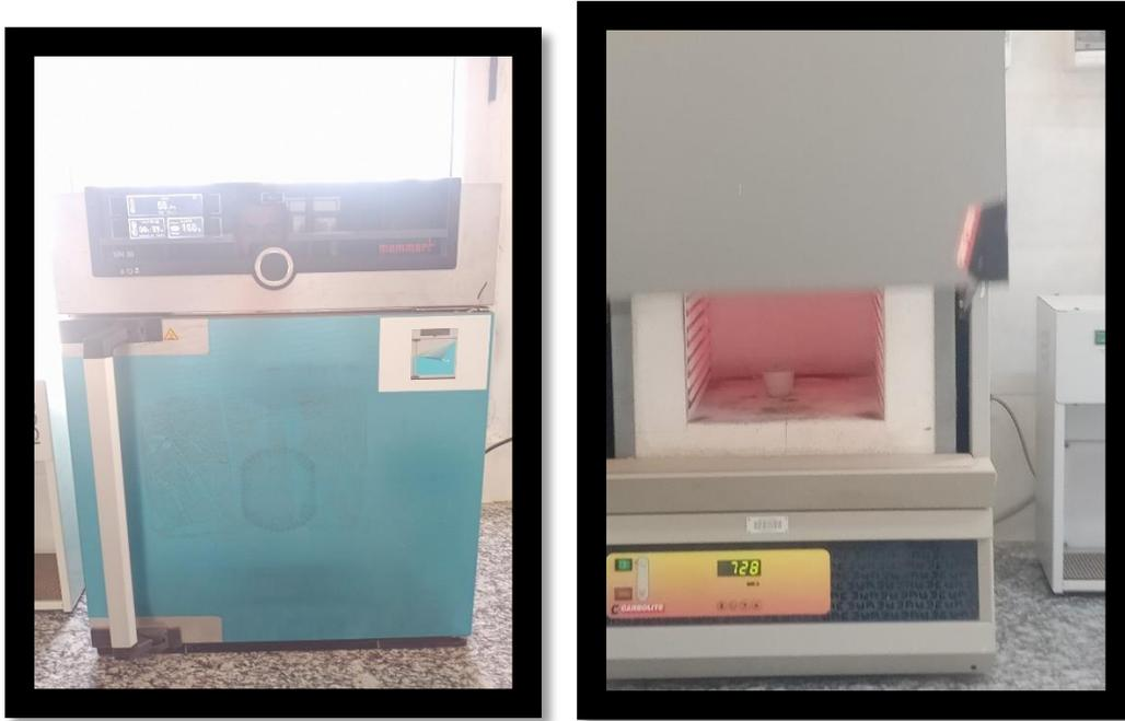
*Figure.IV.5. Four à moufle avec creuset en platine*
