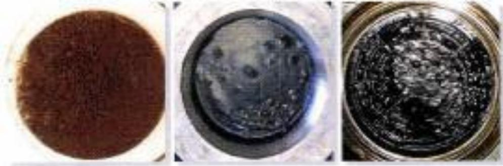
*Variation de la texture du dépôt d'asphaltène en fonction des conditions
