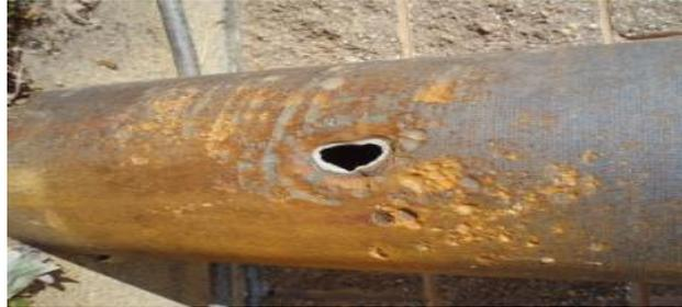
*Figure I.3: Corrosion localisé.*
