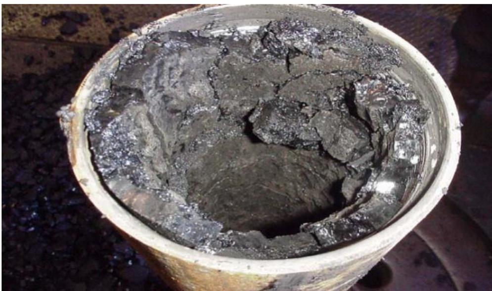
*Figure.II.3. Dépôts des Asphaltènes [17]*
