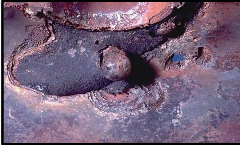
*Fig. I.7. Corrosion galvanique au niveau d'une zone de brasage entre la brasure Cu-P et le tube en cuivre*
