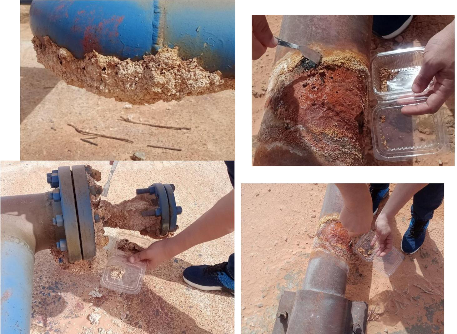
*Figure.IV.1. Un Dépôt d'un puit d'huile*
