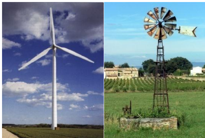
Fig. I. 2. Éoliennes à axe horizontal.
