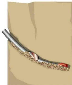
Figure II. 8: Mauvais nettoyage du trou [26].
