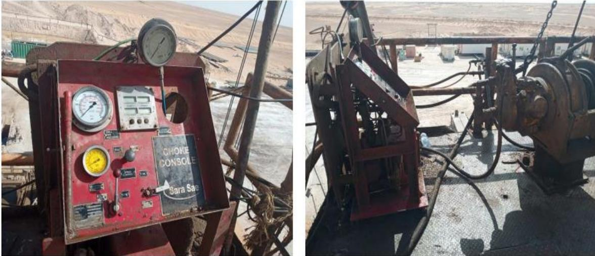
**Figure III.5 : Choke Panel [14].**
