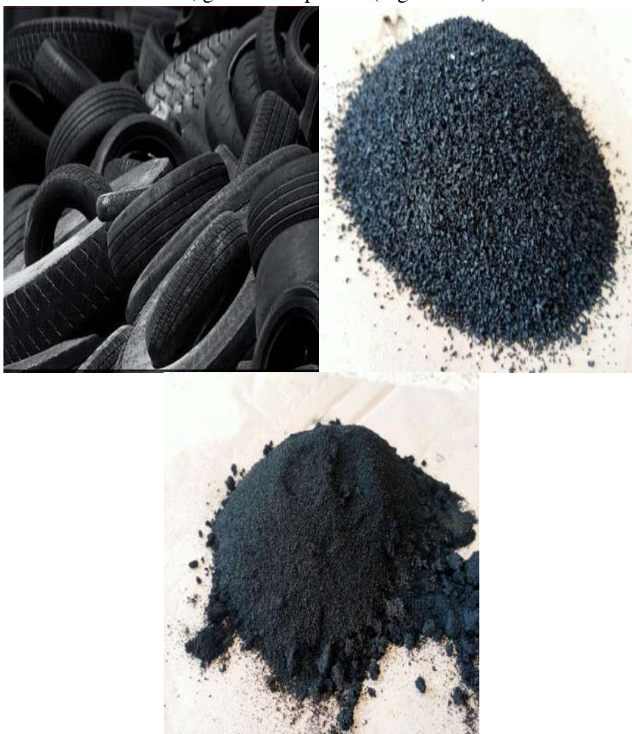
Figure III.9. Déchets de pneus , granulés et poudre de caoutchouc synthétique
