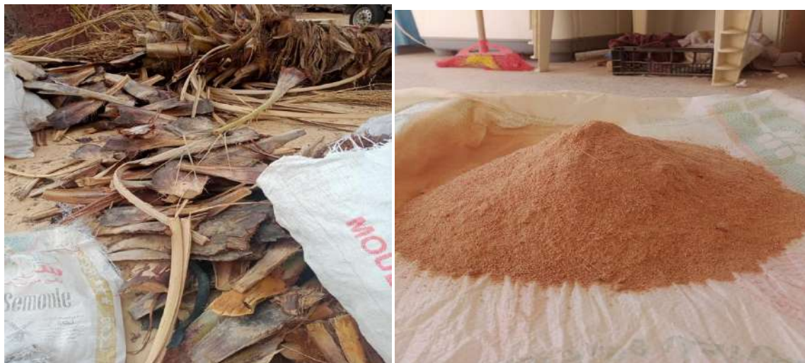
Figure III.12. Déchets de bois de palmier dattier 1 et poudre de bois de palmier dattier 1
