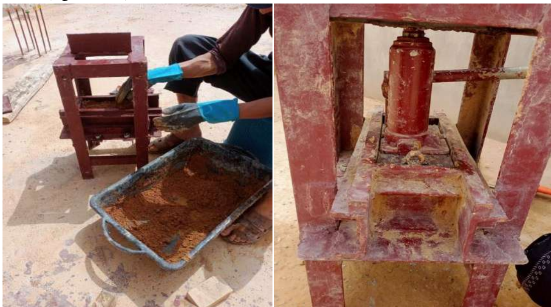
Figure III.15. Dispositif de pression utilisé pour effectuer les échantillons exerce une pression allant jusqu'à 1,2 MPa
