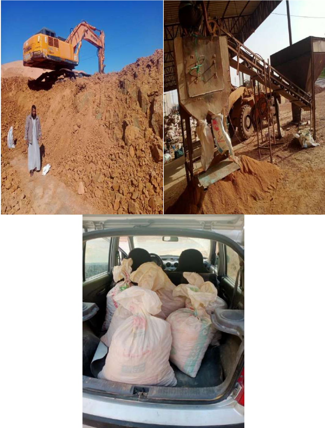
Photo N°1: Extraction de l'argile, sa mouture et son transport
