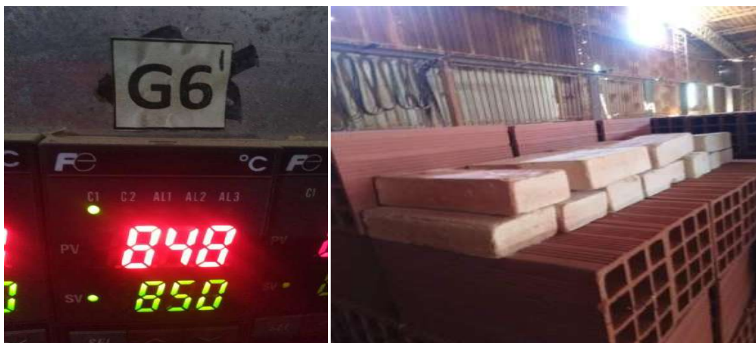
Figure III.16. Cuisson des échantillons dans un four Tunnel, à une température allant jusqu'à 850 degrés Celsius
