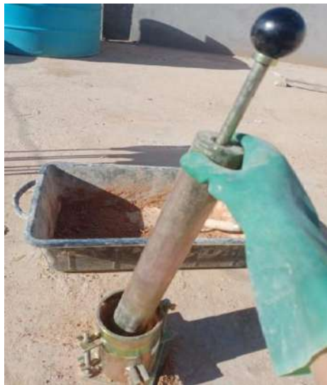
Figure III.21. Moule d'expérimentation de Proctor Normal avec son marteau
