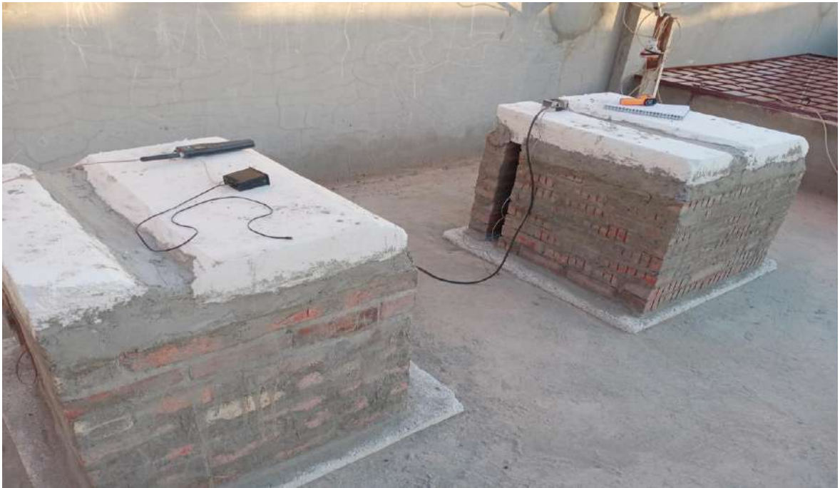
Photo N°7: Tests thermiques des prototypes
