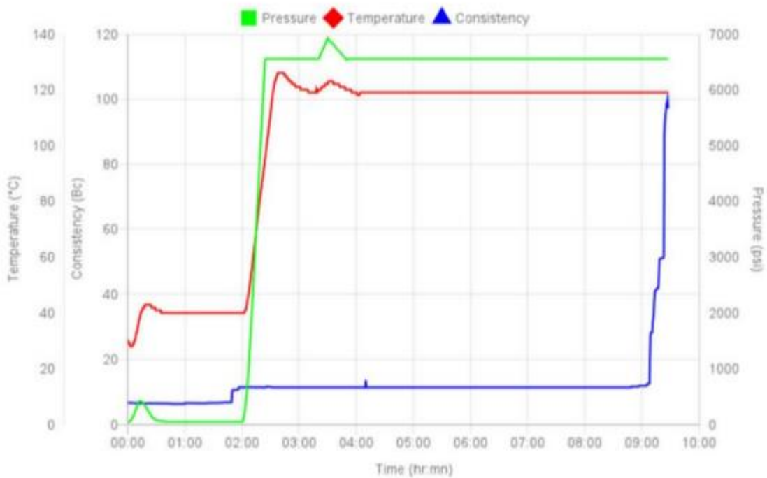
Figure IV.5: La variation de la température, de la pression et de la consistance en fonction du temps pour le slurry Fulcrum MDZ 663.
