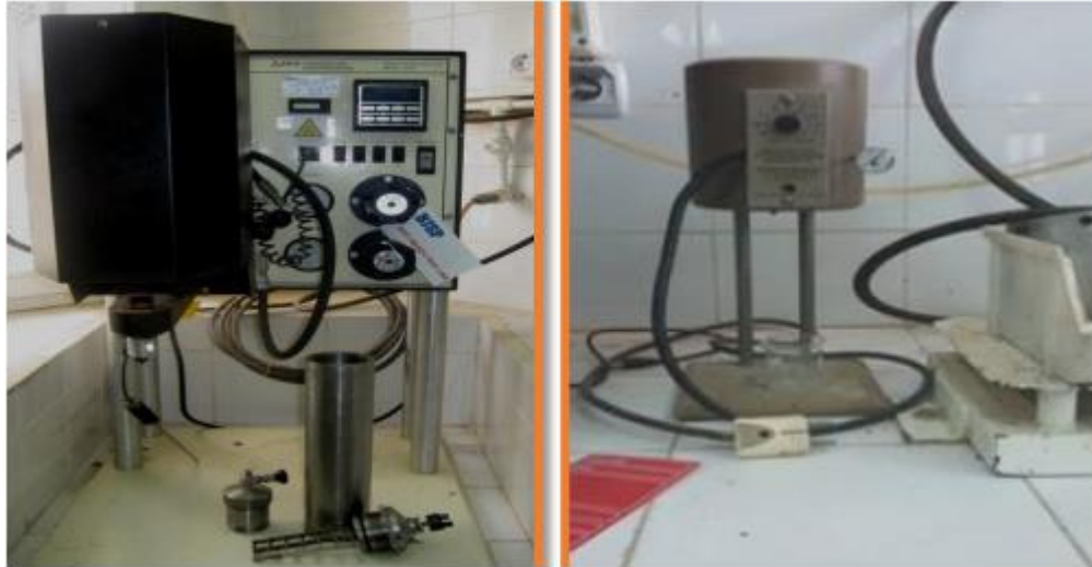
Figure II.20 : Le filtre presse. [10]
