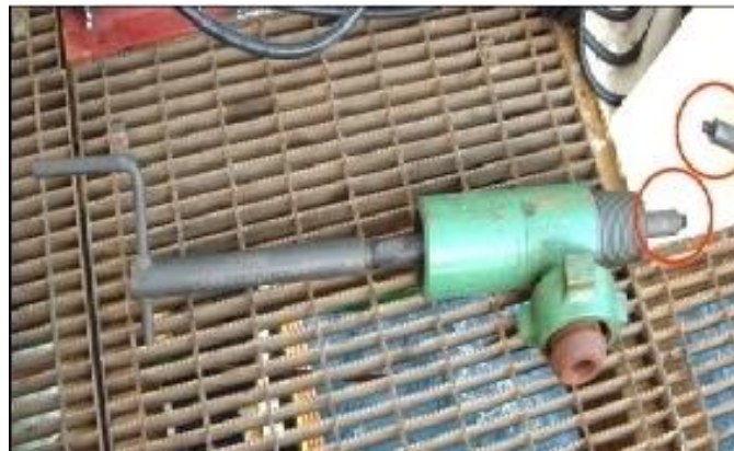
Figure II-25: L'outil de purge des NRV
