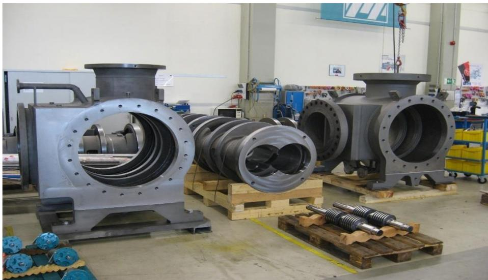
**Figure II.4: Le corps et le chemise de pompe [22]**
