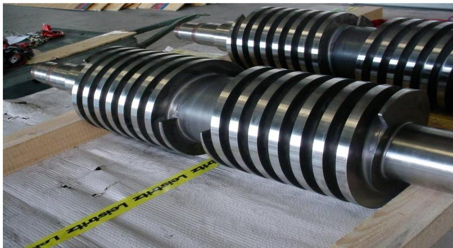
**Figure II.5: le rotor de pompe [22]**
