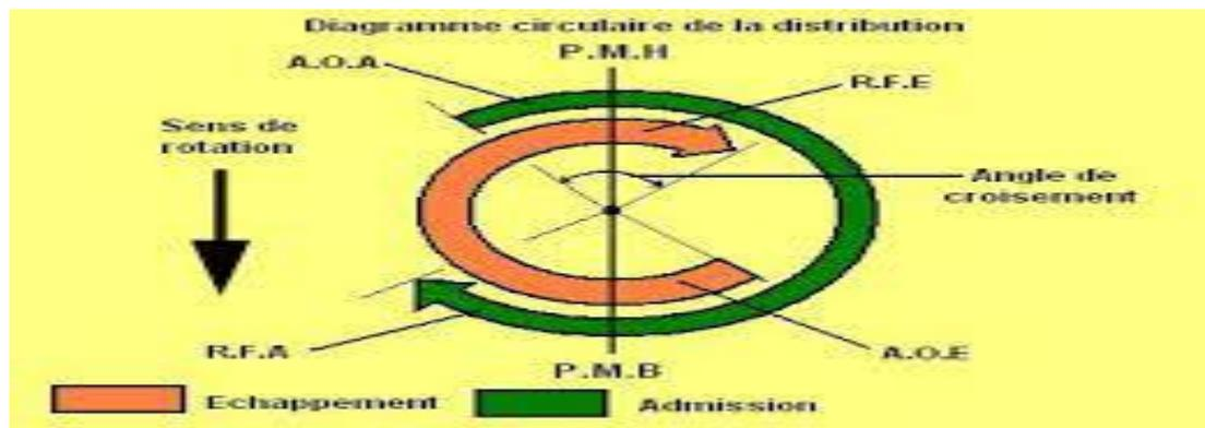
Fig. I.4: retard et avance d'admission et échappement.
