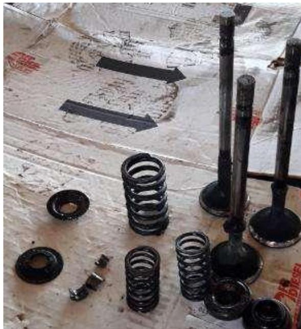
**Fig. II.13:** Les soupapes et ses accessoires
