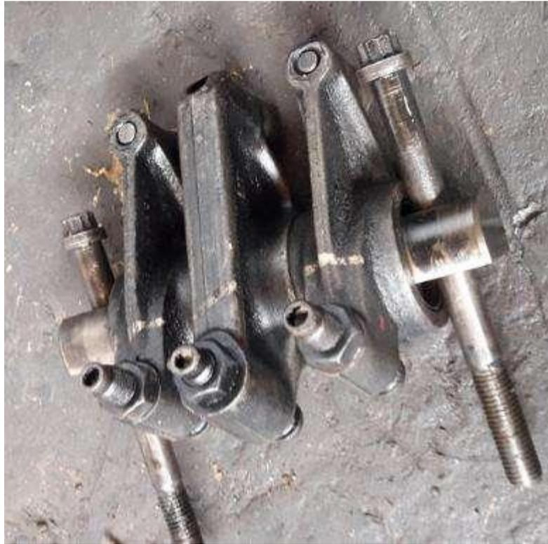
Fig. II.14: Les doigts du culbuteur.
