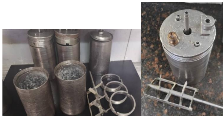
Figure III-15 : La cellule de test de thickening time
