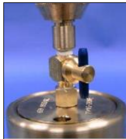
Figure III-10 : Soupape d'entrée de cellule (Cell Inlet Valve (Open))
