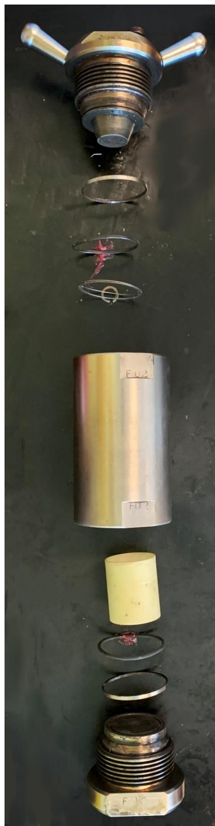
Figure II-15 : les composants d'une cellule d' ACU [27]
