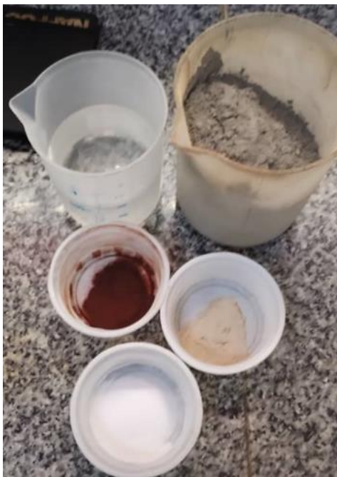
Figure III-1 : préparation du laitier sans SSA-1
