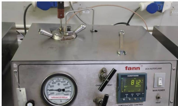
Figure III-30: Start du test ACU
