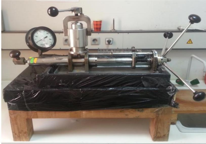
**Fig.15 : Schéma représente la pompe volumétrique [SH-CRD].**
