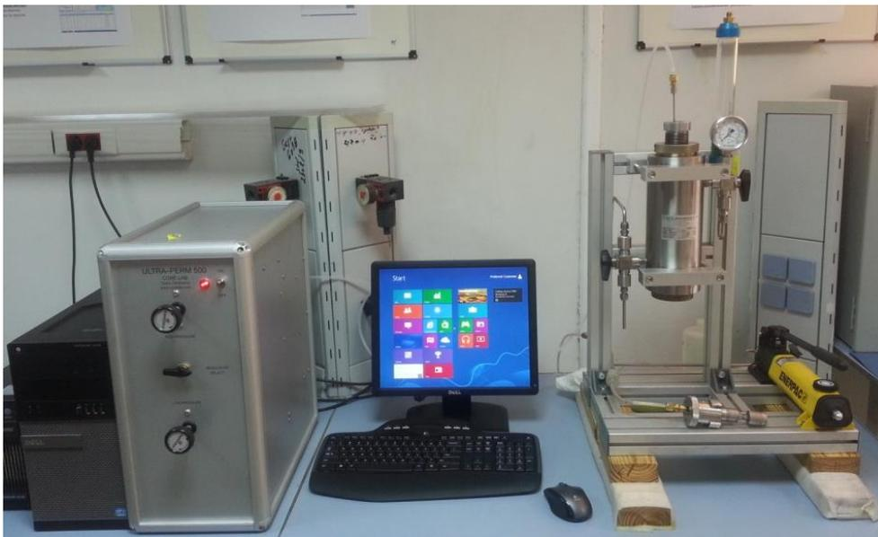
**Fig.13: Schéma représente l'ULTRA- PERM-500.**
