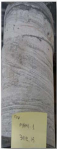
Figure 12 : Laminations Horizontales et obliques
