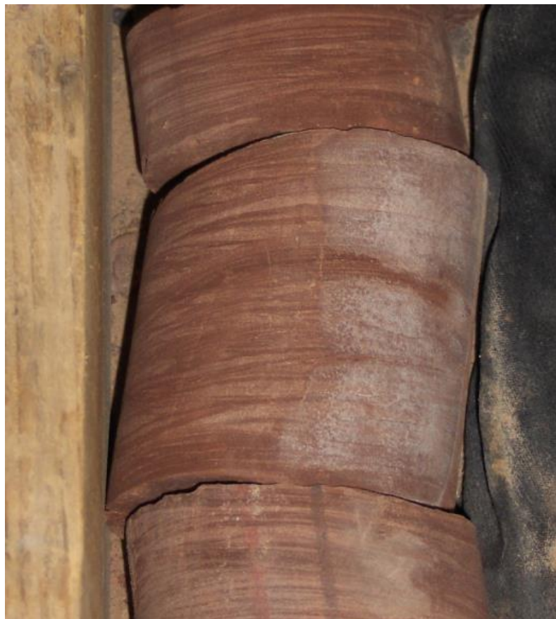
Figure II-27 Echantillon de carotte montrant les grés avec des rides de Courant dans le puits HJR-3
