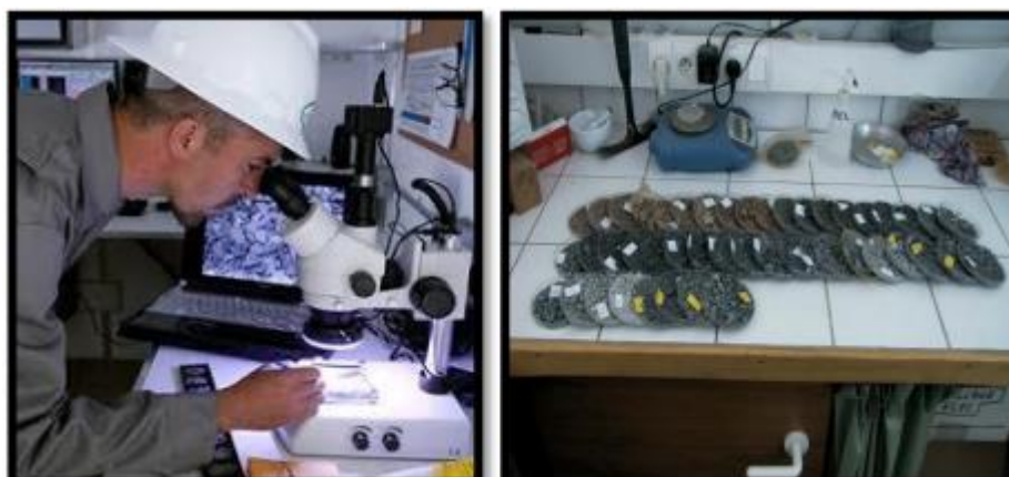
Figure 2.28 : L'analyse des échantillons sur le Microscope Binoculaire
