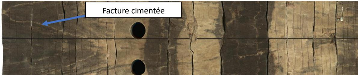
Fig.21: types de fracture fermée dans le puits HDZ-17
