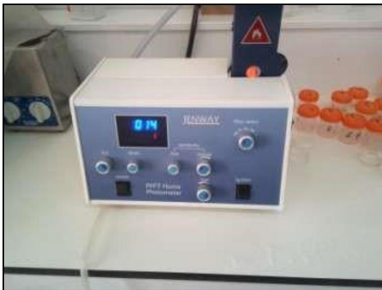
**Figure 19 : Le spectrophotomètre à flamme, de marque JENWAY**
