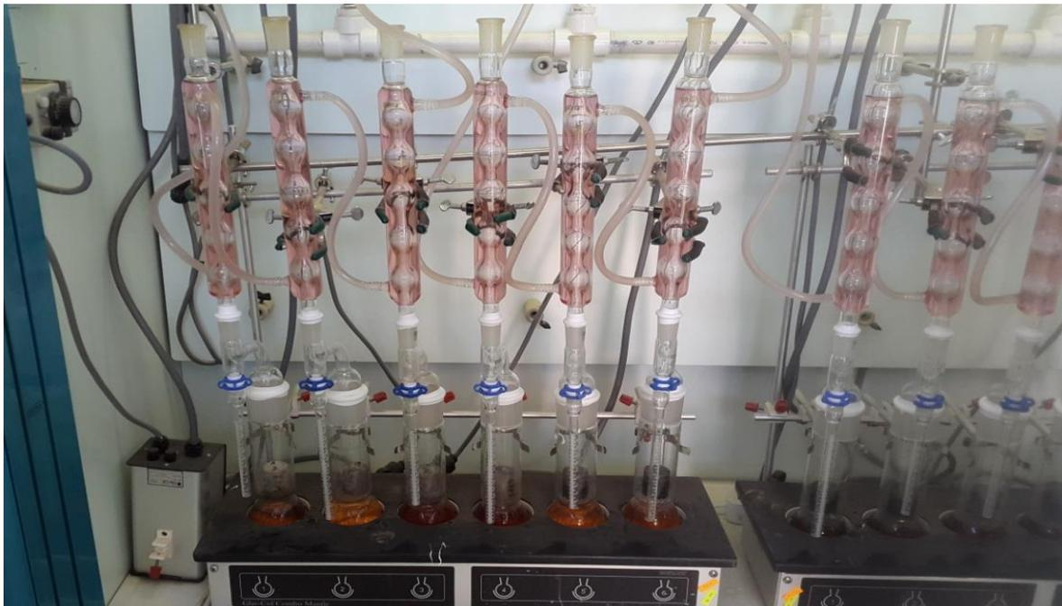
**Fig.24:** Schéma représentant l'appareil Dean Stark.
