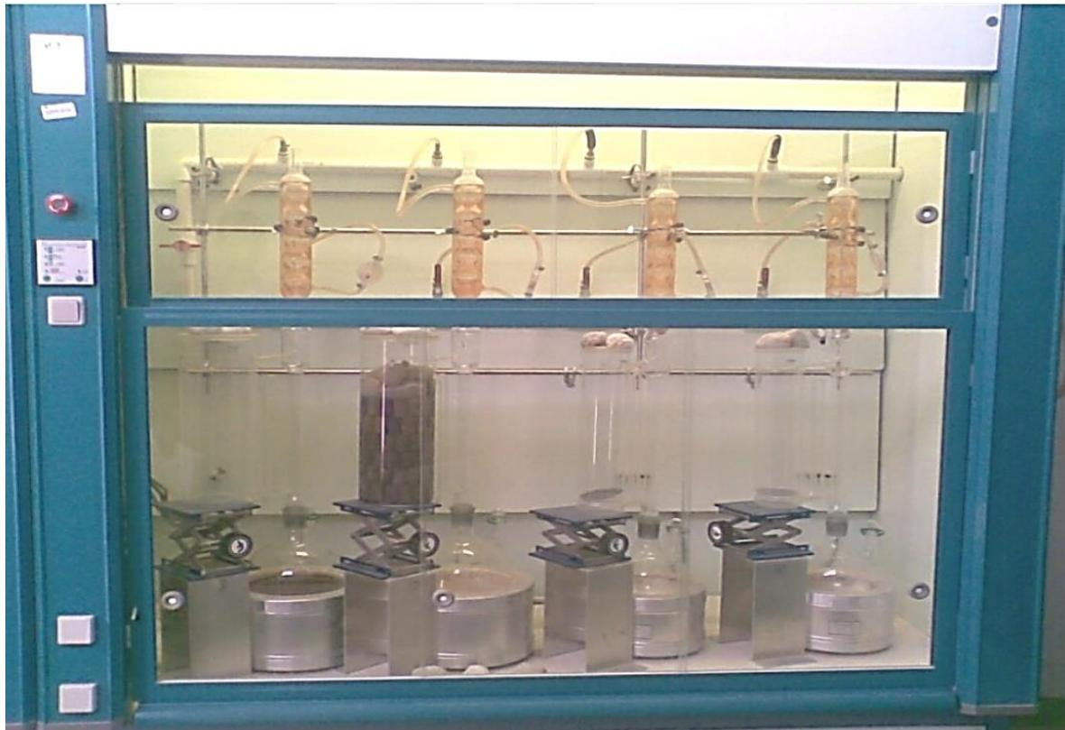
**Fig.16:** Schéma représente les soxhlets[22]
