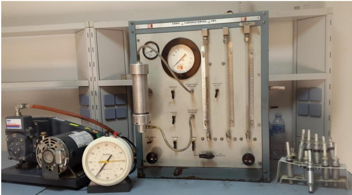
**Fig.19:** Schéma représente l'appareil de perméamétrie standard
