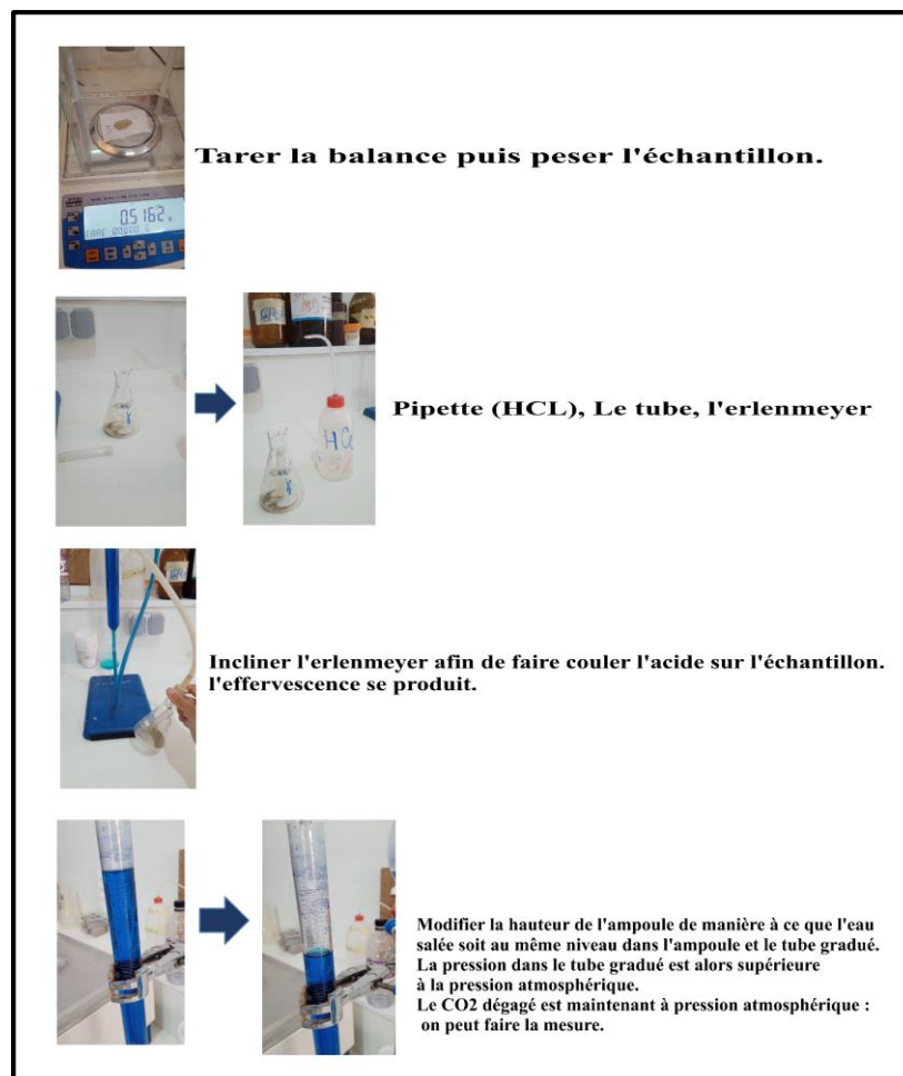
Fig.08 : Étapes et outils utilisés dans un calcimètre de Bernard. (Laboratoire de Géologie du Sahara, Université d'Ouargla).
