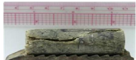
Rupture @  $P_c=5\text{MPa}$  Rupture @  $P_c=10\text{MPa}$
