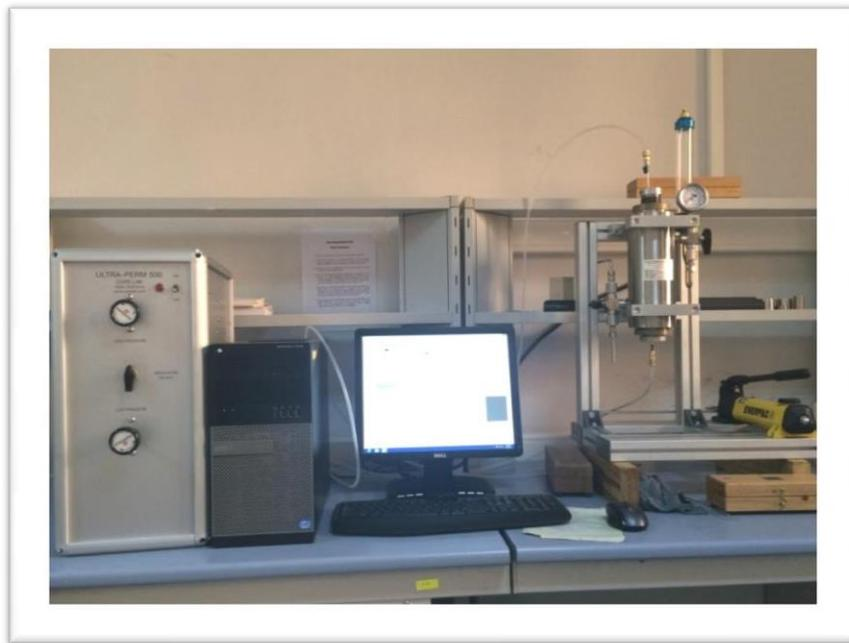
**Figure II. 9 :** Mesure la perméabilité par l'appareil ultra perm-500
