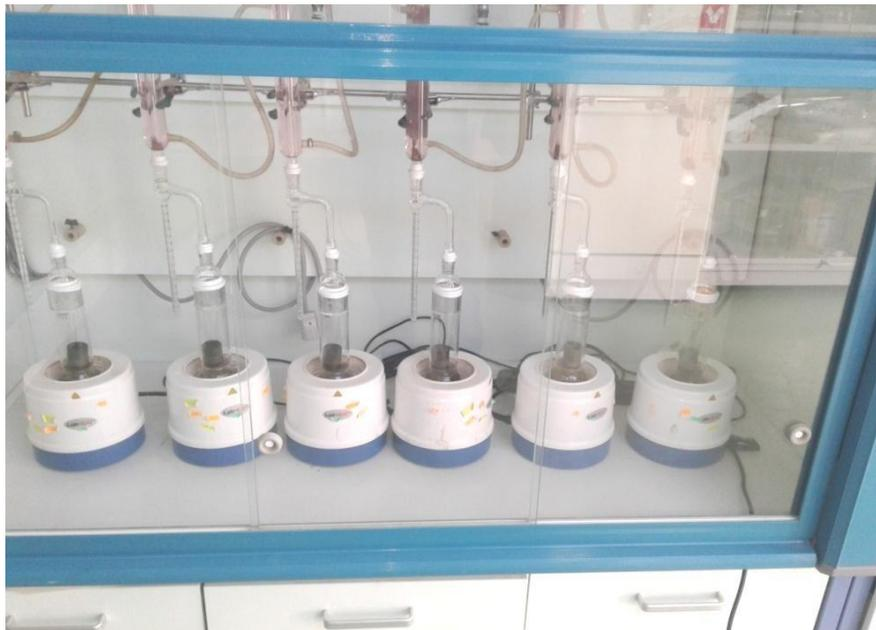
**Figure II. 5 : Mesure de la saturation à méthode Dean Stark**
