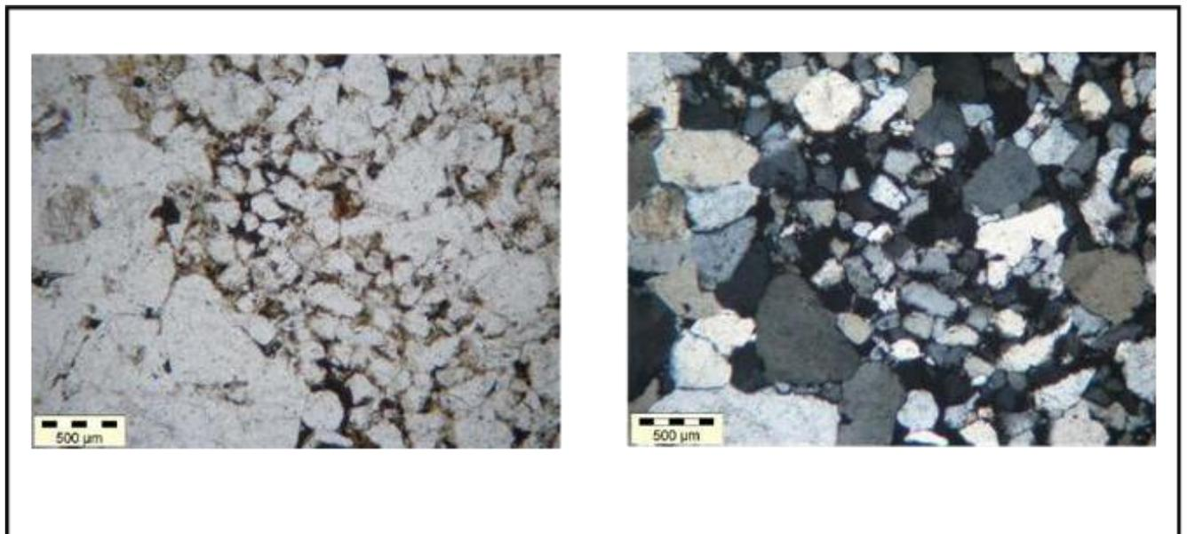
**Figure IV. 54 :** Grès fin à moyen, mal classé, sub anguleux à sub arrondie à ciment siliceux (Côte 3392m, puits n° 3).
