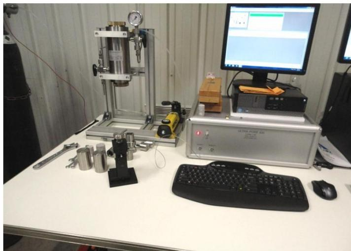
**Figure II. 7 :** Mesure du volume total (ULTRA-PORE 300)
