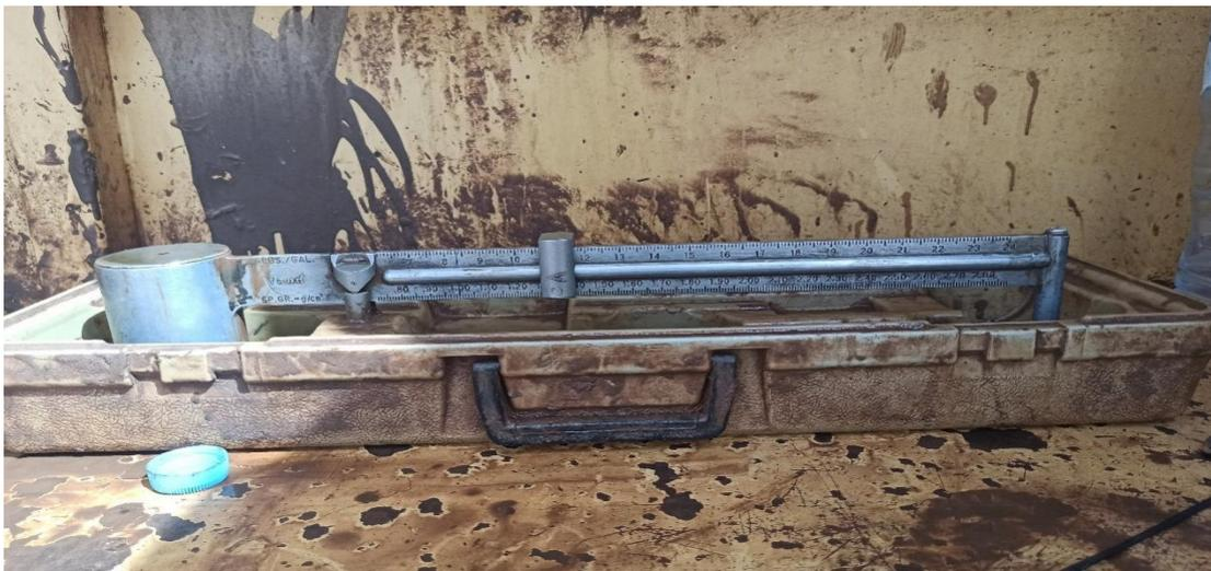
Figure 16 Appareil de mesure de densité et de gravité
