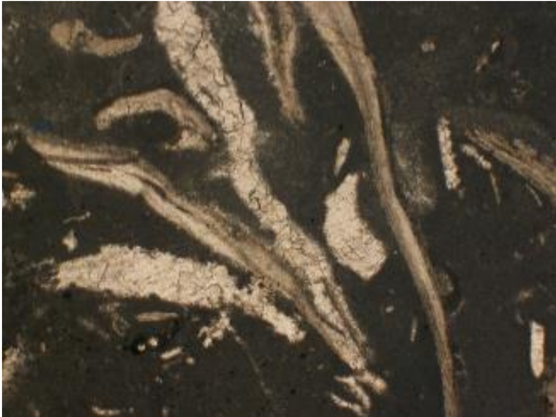
Figure-10 Détail de la Figure 08, montrant une texture packstone à bivalve ou gastéropode (1518 Ln x2).
