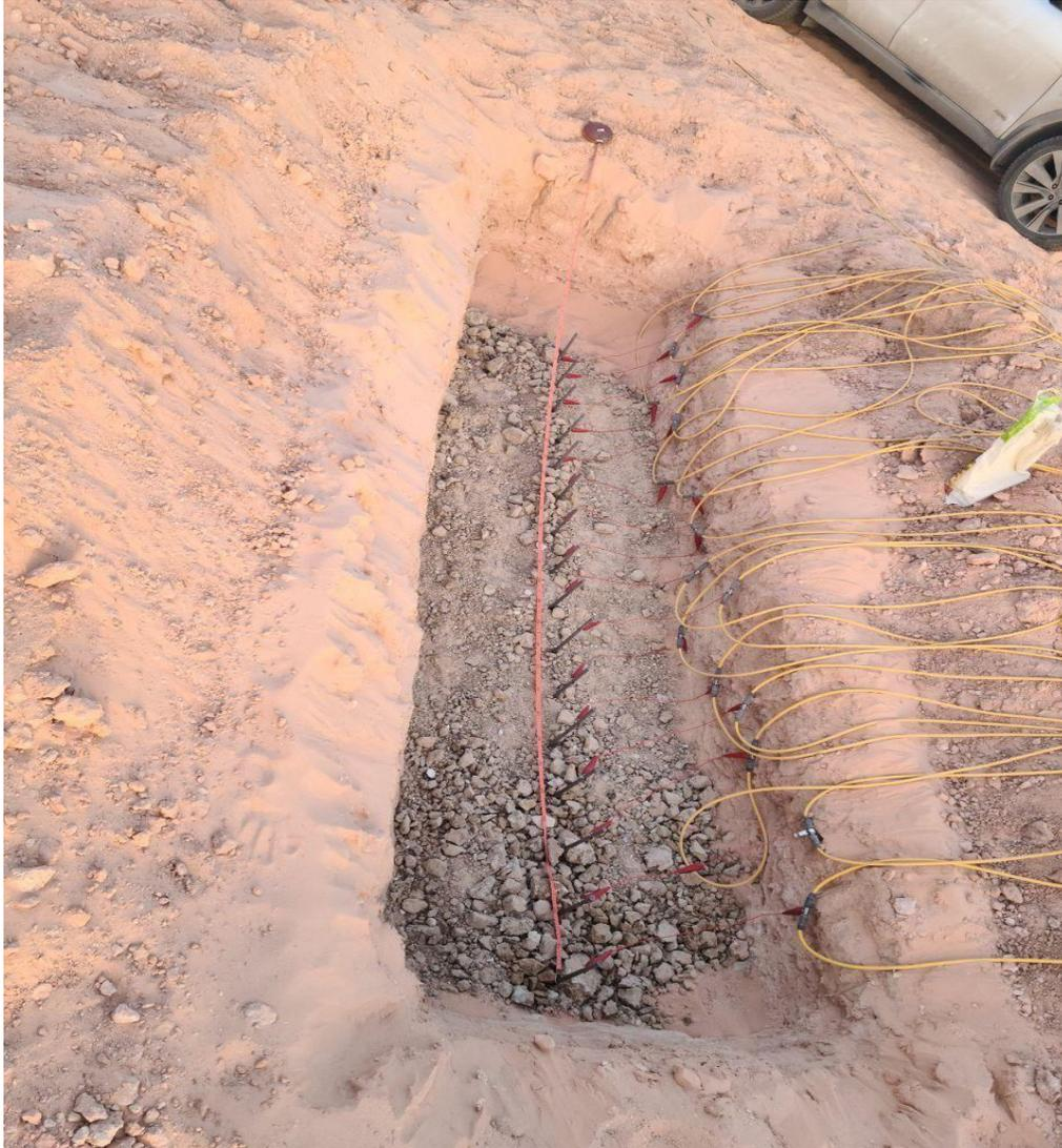
***Fig.II.15. Placement des électrodes pour la mesure (argile)***
