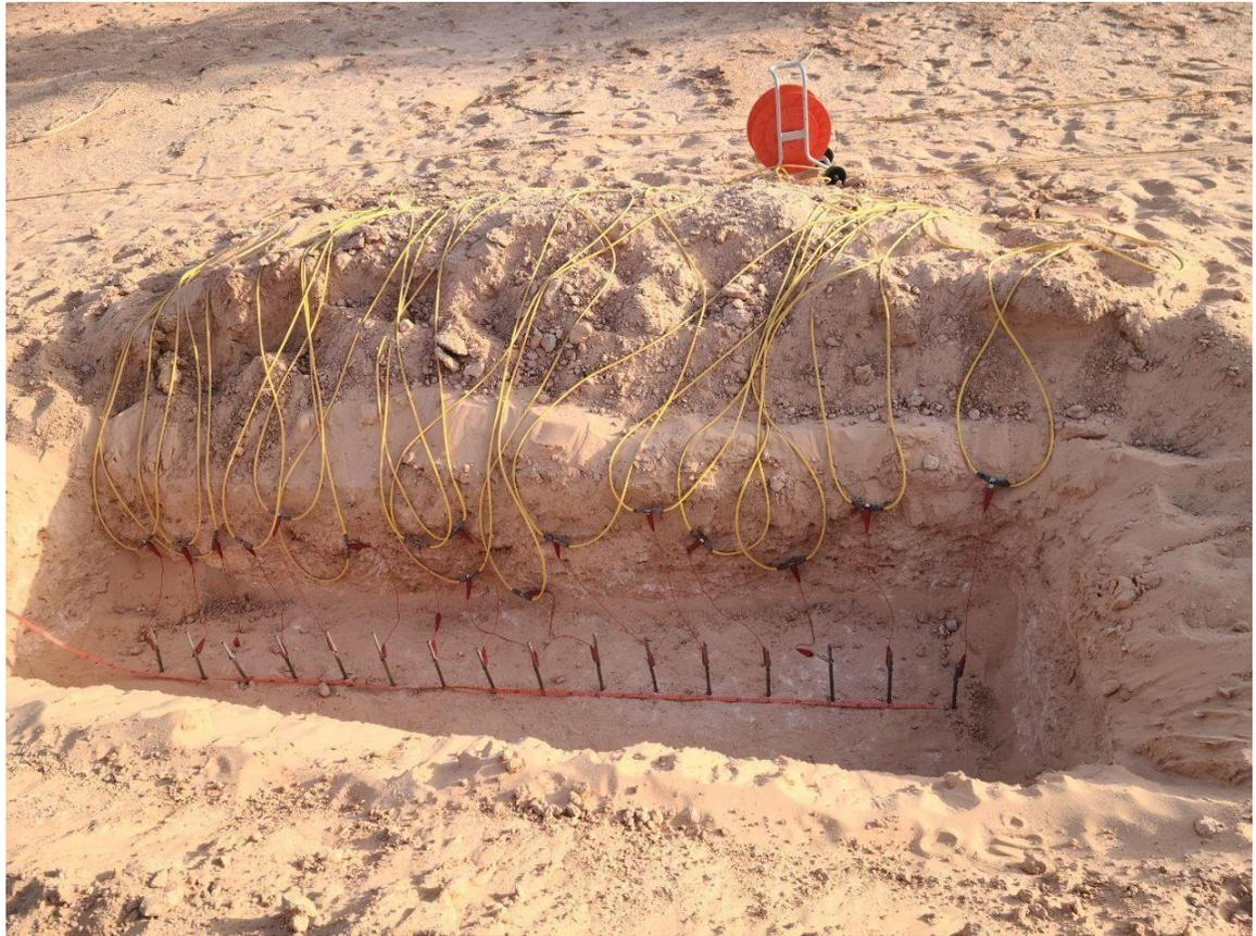
***Fig.II.14. Placement des électrodes pour la mesure (gypse)***
