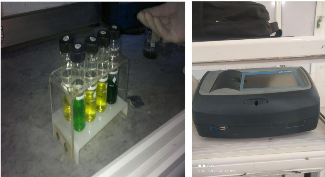
**Figure 24** : Spectrophotomètre DR3900
