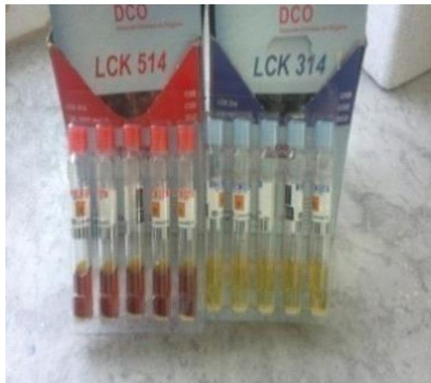
**Figure 25:** Matériel utilisé pour déterminer la valeur de DCO
