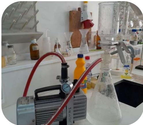
جهاز الترشيح تحت التفريغ
