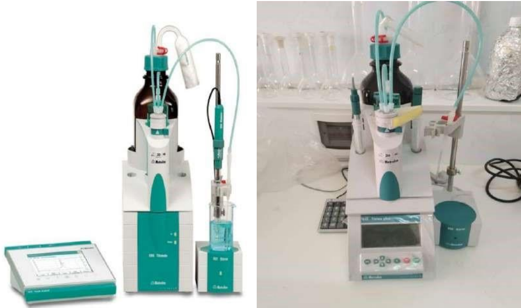
الشكل 23: مقياس جهد أوتوماتيكي من نوع ميتروم.
