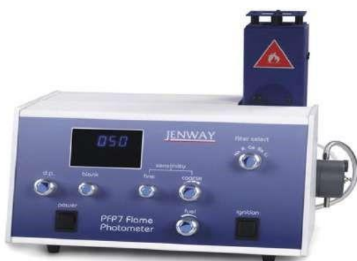
الشكل 19: مقياس الطيف الضوئي لانبعث اللهب من النوع JENWAY PFP7
