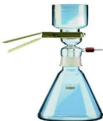
الشكل 18 : جهاز ترشيح فراغي زجاجي مع وصلة أرضية.
