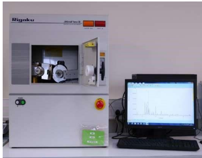
الشكل 26 : مقياس حيود الأشعة السينية من نوع ريجاكو.
