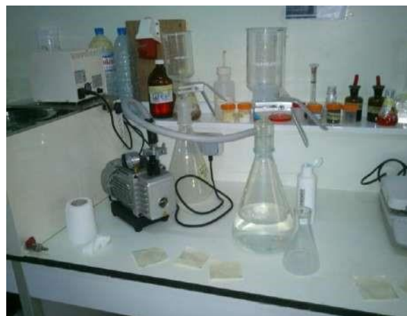
الشكل 18 : جهاز ترشيح فراغي زجاجي مع وصلة أرضية.
