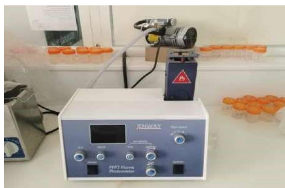
الشكل 19: مقياس الطيف الضوئي لانبعث اللهب من النوع JENWAY PFP7
