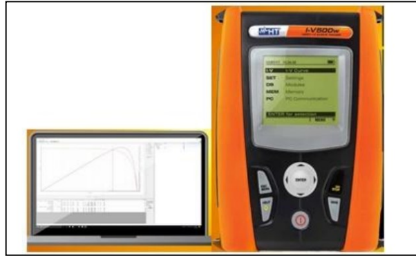
الشكل II-7: جهاز اختبار الطاقة الشمسية I-V500w
