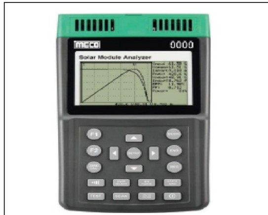
الشكل II: 9- محلل وحدة الطاقة الشمسية MECO
