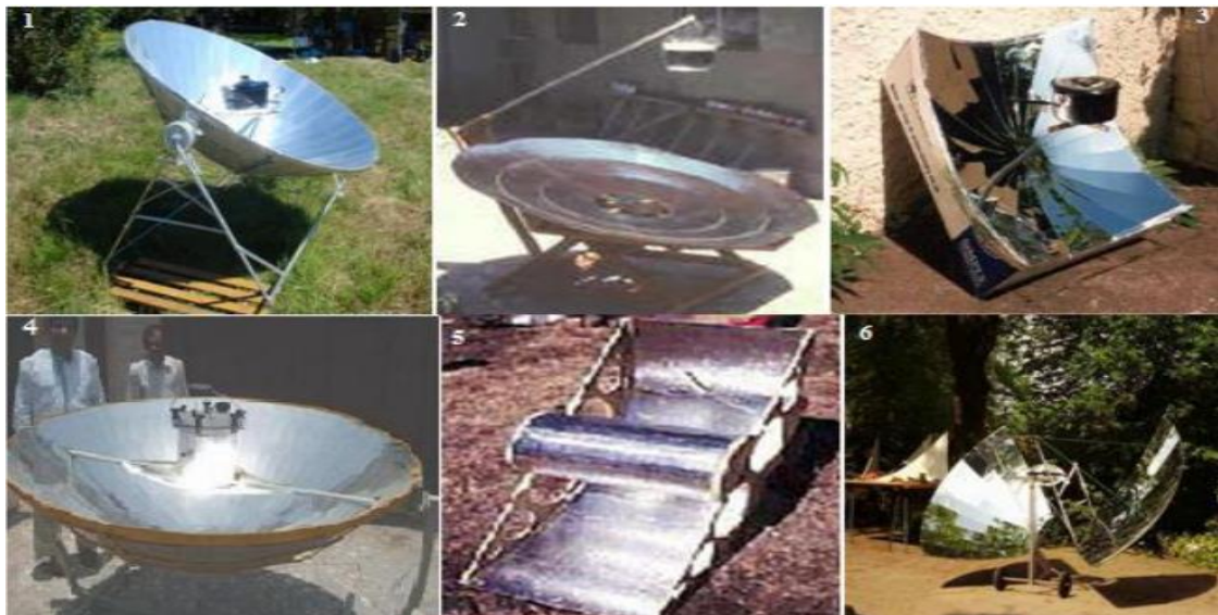
Figure I.9: Cuiseur solaire à concentration : 1- parabolique, 2- parabolique orienté vers le haut, 3- forme carrée concave, 4- sphérique, 5- cylindre-parabolique, 6- à parois réfléchissantes en forme d'aile.
