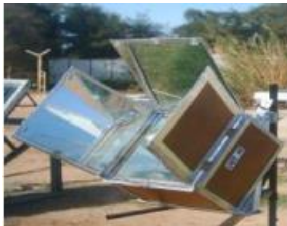
Figure I.20: Cuiseur solaire boîte réalisé et testé à l'URER /MS par Harmim et al. [30].
