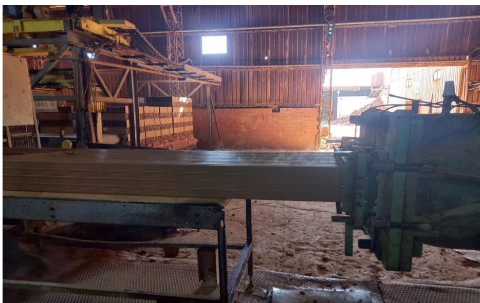
Figure II.5 : Façonnage mécanique de briques [28]
