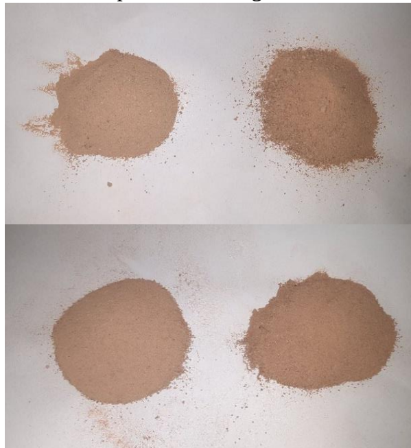
Figure III.16 : Mélanger le Kernef broyé avec de l'argile en différentes proportions
