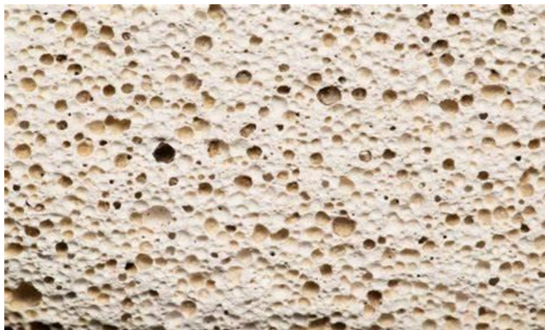
Figure I.10 : Le bloc mono mur en pierre ponce [8]
