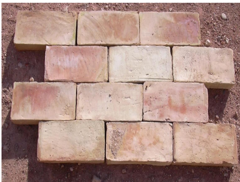
Figure II.4 : Briques façonnées à la main [29]
