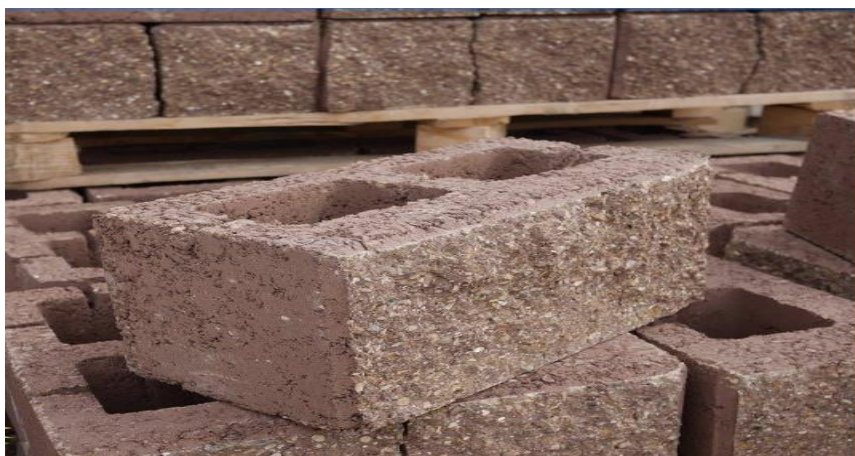
Figure I.9 : Le bloc mono mur en argile expansée [7]
