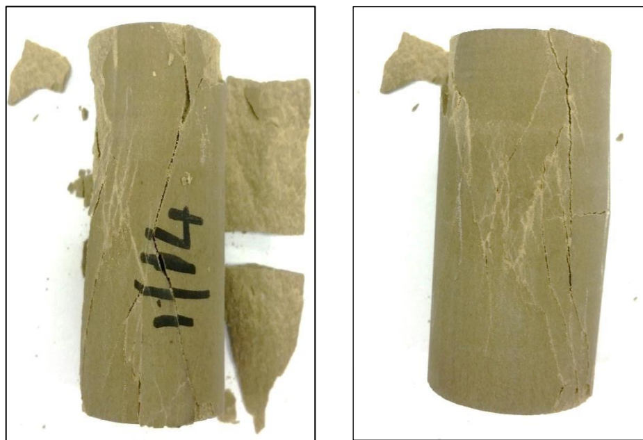
Figure III.4 Schéma de rupture d'une roche saturée brin (Sample 1-14)
