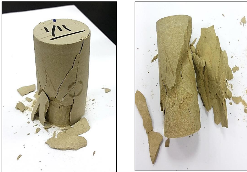
Figure III.2. Schéma de rupture de la roche sèche (Sample 1-11)
