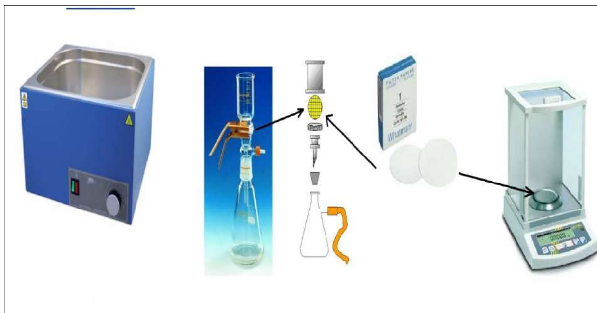
Fig.28. Dosage des ions sulfate par gravimétrie.
