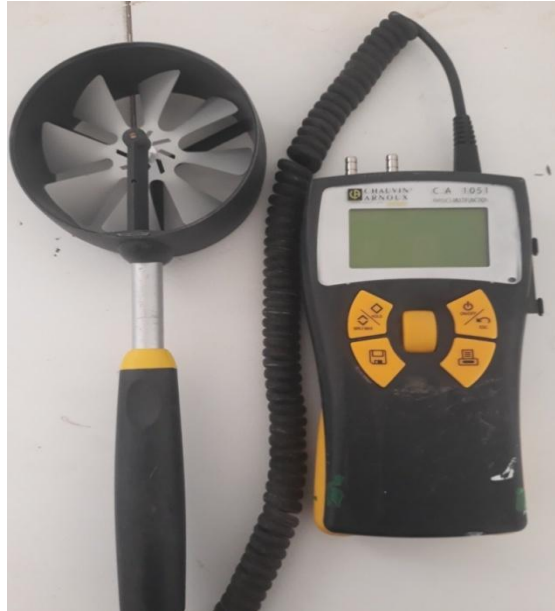
Figure. II-9 : anémomètre attaché à un module C.A1051.
