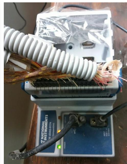
La station d'acquisition de données type NI cDAQ-9174
