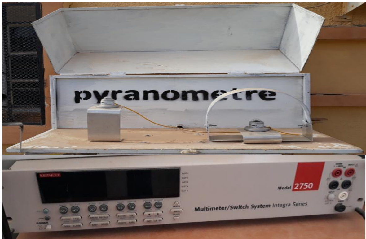
Figure. II-7 : Pyranomètre mesure de Le rayonnement solaire
