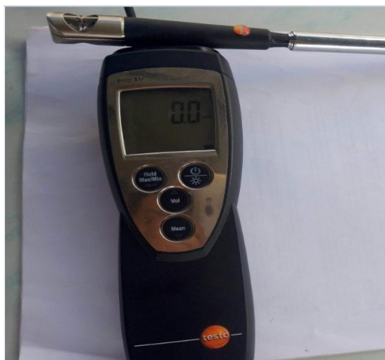
Figure. II-10 anémomètre à de marque testo 416
