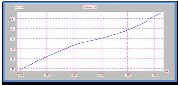
Figure (2) : La courbe de polarisation de l'acier X70 dans une solution de \text{H}_2\text{SO}_4 0.5M
